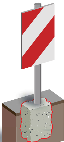
FISSAGGIO DI INSEGNE STRADALI, PALI
