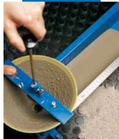
Prova di scorrimento secondo EN 13395-2
